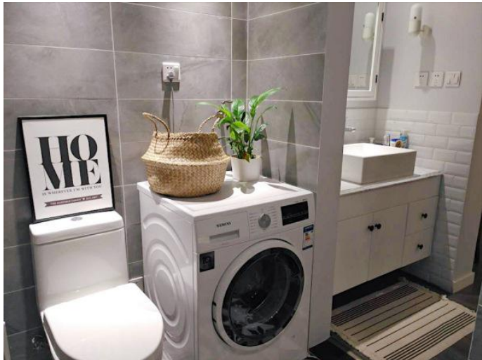
5、 智能马桶盖需要三孔插座，一般位于远离淋浴的马桶那侧，距地面不低于 0.3 米。
